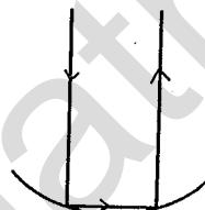
विज्या  $R$  के अर्धगोलीय दर्पण से दो बार परावर्तित एक प्रकाश किरण, आपतित किरण के समांतर निकलता है (चित्र को देखें)। मूल आपतित किरण व अंतिम परावर्तित किरण के बीच की पृथकता है
